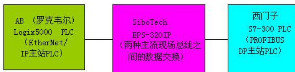
图 1 工业以太网转 PROFIBUS DP 网关相关的通讯简易框图
